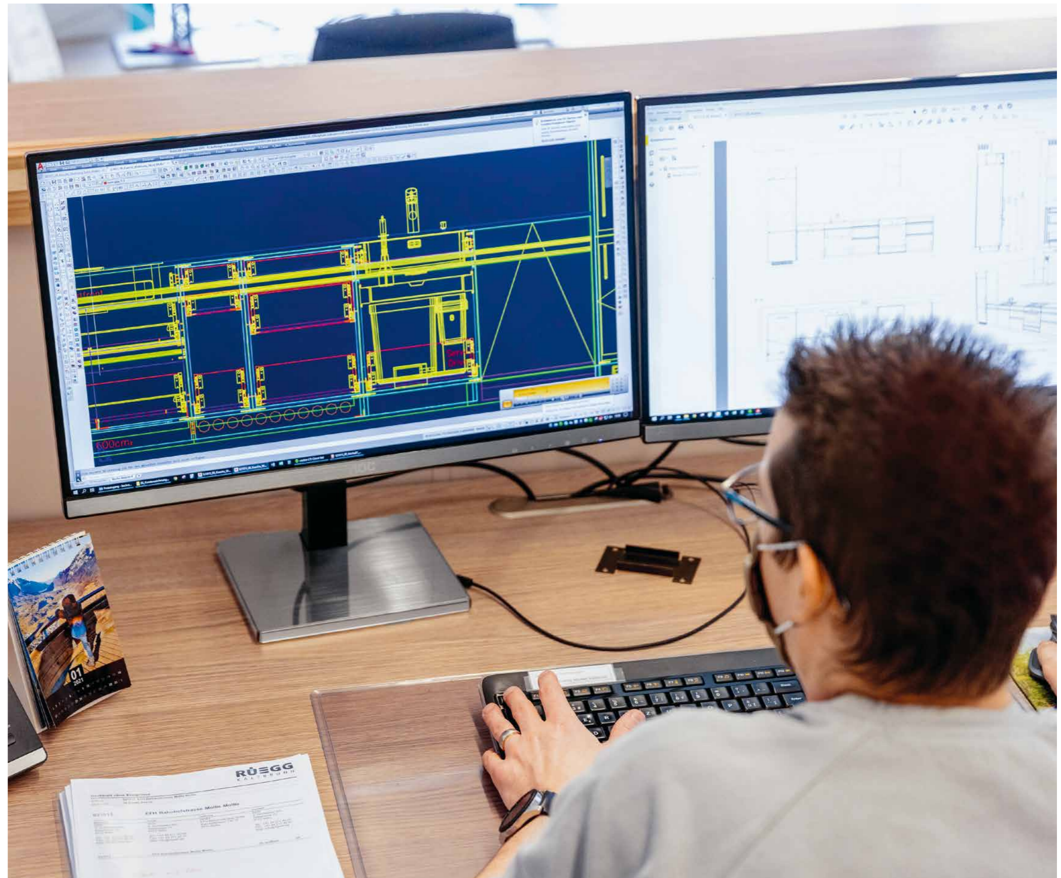
Alla W. Rüegg AG i disegnatori elaborano offerte digitali sulla base di idee o dei disegni dei clienti. Nel sistema CAD tutti i singoli mobili sono salvati in blocchi.
