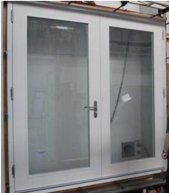
Foto: zweiflügliges Element bei der Schlagregenprüfung
