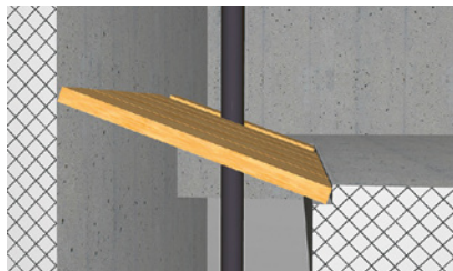
2 Kleine Bodenöffnung im Wandbereich mit verkeilten Brettern
